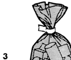
Figure 37 : Scellage des sacs avec ruban adhésif : 1) le sac est tordu, 2) l'extrémité tordue est passée dans la machine et le ruban auto-adhésif se colle autour, 3) le sac scellé.
