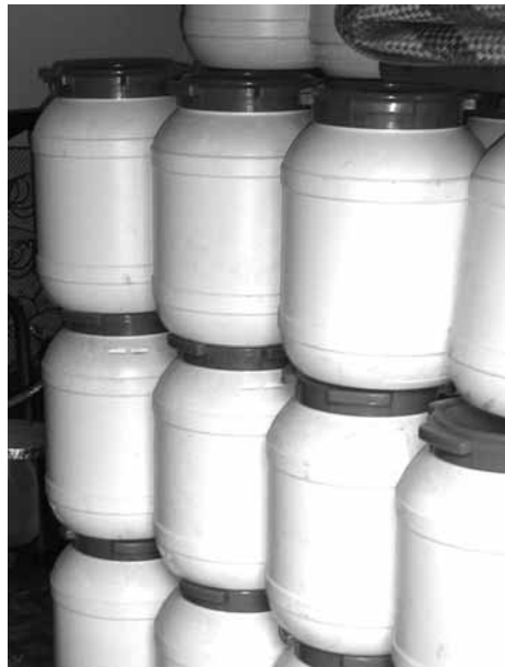
Figura 15: Os tambores de plástico de grau alimentar são geralmente brancos, mas a cor em si não constitui nenhuma garantia que o material de plástico é de grau alimentar.
