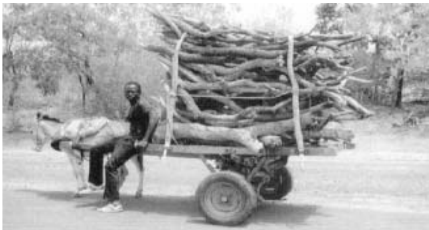
Figura 32: Carroça com duas rodas puxada por um burro no Mali. Caso a carga esteja bem equilibrada, os burros podem puxar cargas impressionantes sobre estradas planas.
