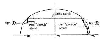
Figura 16: Resguardo no interior de um túnel: corte transversal
