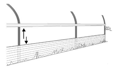
Figura 11: Ventilação lateral por enrolamento na parte vertical do casco
