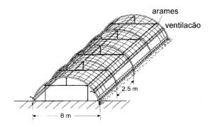
Figura 8: Túnel onde se utiliza filme plástico mostrando um corte transversal (perfil transversal) e uma ventilação lateral de enrolamento (que também é aplicada nas construções duplas em arco, acopladas)
