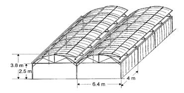
Figura 9: Construção dupla (dois túneis em arco, acoplados) com ventilação no telhado, efectuada através da sua deslocação, total ou parcial
