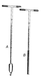
Figura 28: Sonda do solo Deelman (A) furo de sonda/perfurador manual para amostra de solo para 0,5 metros de profundidade (B)
