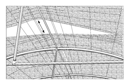
Figura 12: O sistema de ventilação funciona puxando-se cordas que abrem fendas numa estufa revestida de filme plástico
