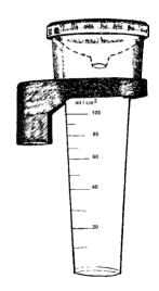
Figura 26: Instrumento de medição do nível da chuva - pluviómetro
