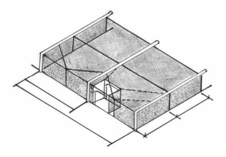
Figura 25: Culturas de viveiro numa pequena estufa à prova de insectos com uma comporta de entrada (Rovero)
