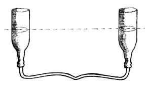
Figura 29: Nível manual feito de duas garrafas de plástico sem fundo
