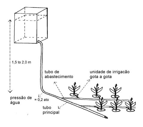
Figura 23: Sistema de irrigação gota a gota (esquemático)
