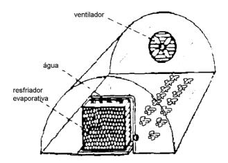
Figura 22: Arrefecimento do ar de superfície húmida – sistema de resfriador evaporativo e de ventilador
