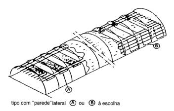
Figura 15: Resguardo no interior de um túnel
