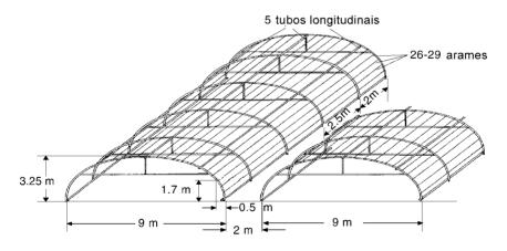
Figura 6: Túnel com uma construção sólida
