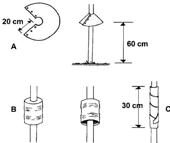
*Figura 10: Exemplos de dispositivos contra ratos. A. gola metálica B. lata de metal invertida C. faixa metálica enrolada em volta da estaca*
